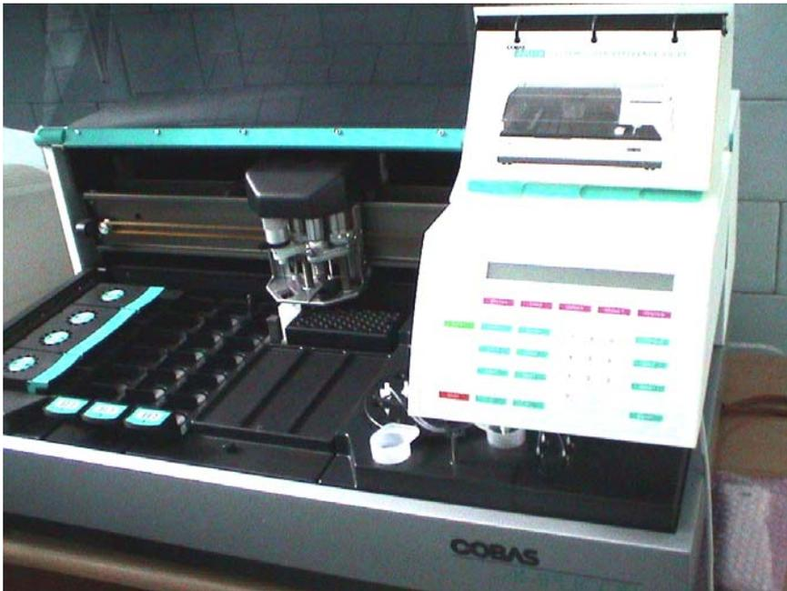
Рисунок 13.8. Прибор для оценки вирусной нагрузки (система Ампликор).
